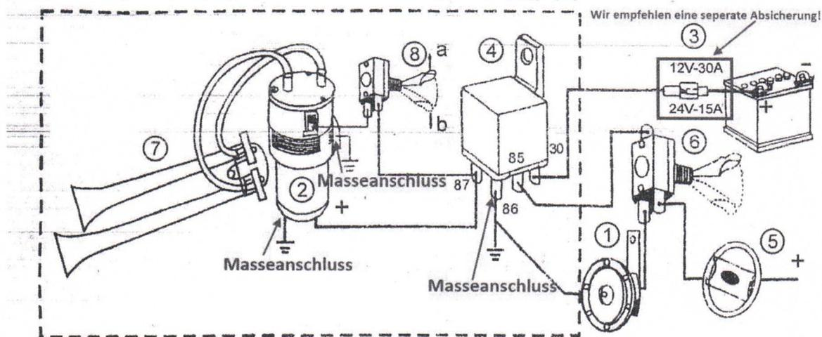
Hupe ist mit dem positiven Pol (+) am Druckschalter angeschlossen, wie die bestehende Standardhupe.
