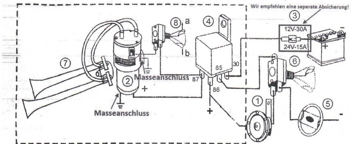
Hupe ist mit dem negativen Pol (-) am Druckschalter angeschlossen, wie die bestehende Standardhupe.
